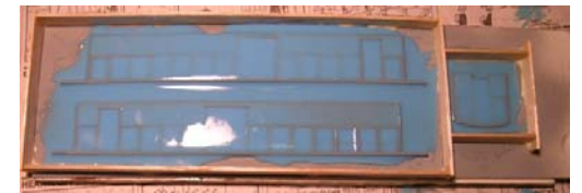
Build the Mold Box & Fill
